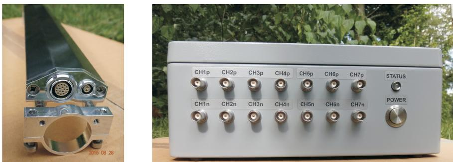
Abb. 2: Links: AD-Wandler Einheit mit Buchsen zum Anschluss des Bohrloch Sensortools und der Stromversorgung. Rechts: DA-Wandler Einheit mit 2x7 BNC Buchsen zum Anschluss eines Datenloggers.
