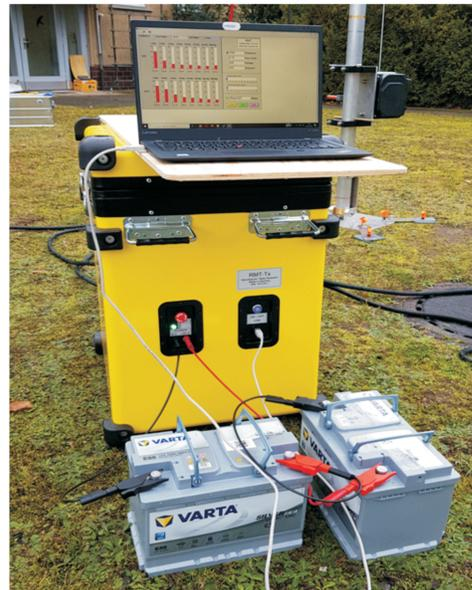
**Abb. 2:** Der RMT-Generator gesehen von der Bedienelementenseite, zusammen mit den beiden Batterien und einem zur Initialisierung des Generators benötigten Laptop PC.
