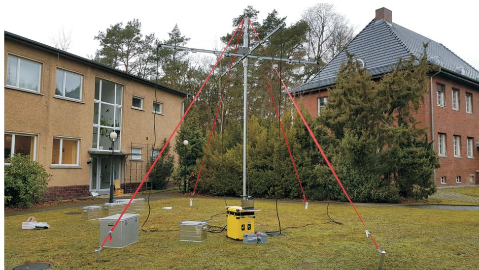
**Abb. 1:** RMT-Transmitter bei einem Testaufbau in Niemegk. Der Signalgenerator (gelbe Box) speist zwei Hochspannungssignale in das Antennensystem. Letzteres besteht aus zwei aufgerichteten Spulen, die azimutal um 90 Grad gegeneinander gedreht aufgehängt sind.
