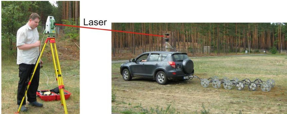
Abb. 11 Messwertpositionierung über Tachymeter
