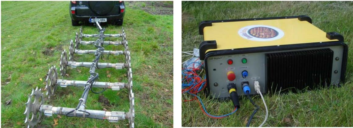
Abb. 2 Komponenten des Messsystems GEOPHILUS ELECTRICUS
